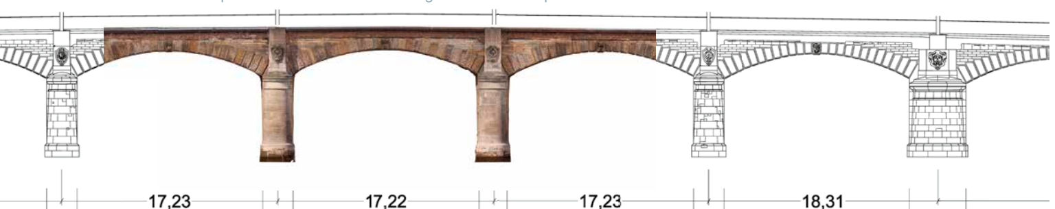
Generiertes Orthophoto und damit erstellter steingenaue Bestandsplan
